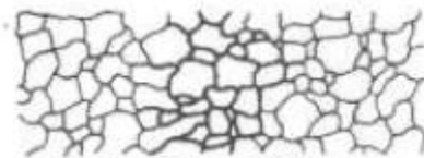
CORROSÃO INTERGRANULAR (MICROGRAFIA)
