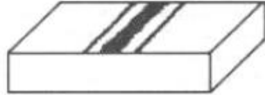
CORROSÃO EM TORNO DE SOLDA
