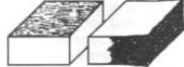
CORROSÃO POR ESFOLIAÇÃO
